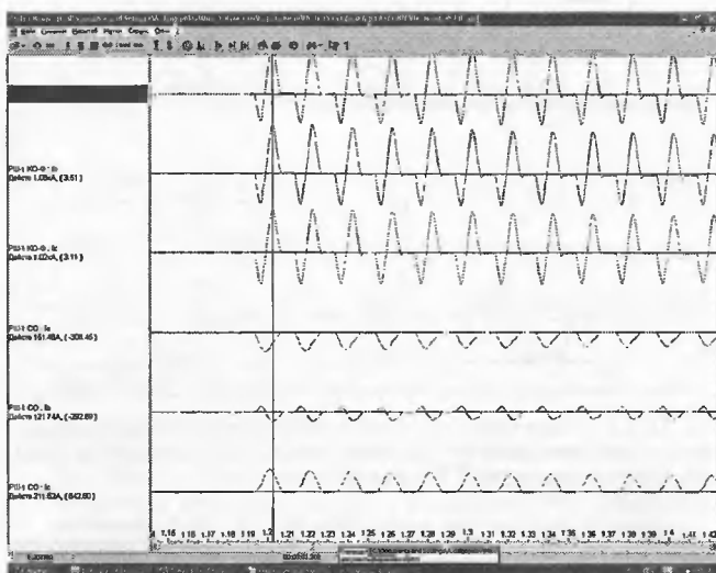
Рис. П12.3. Очередное включение ( I_{\max KO} = 3,5 \text{ кА} , I_{\max CO} = 613 \text{ А} )
